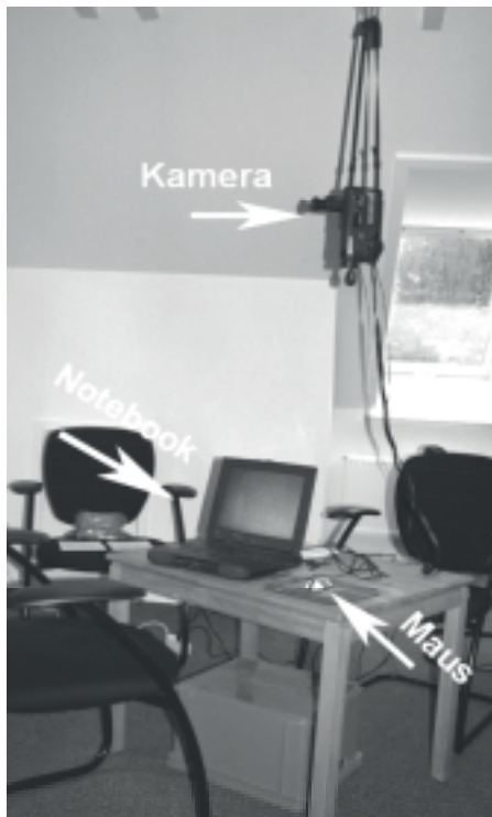
Abb. 1: Der mobile Versuchsaufbau bestand aus dem Arbeitsplatz mit dem Computer und einer darüber aufgehängten Kamera. Um eine gute Sitzhaltung für die Kinder zu gewährleisten, wurden die Füße mit unterschiedlich großen Kisten unterstützt, gegebenenfalls wurde auch die Sitzfläche durch das Unterlegen von Kissen erhöht.
