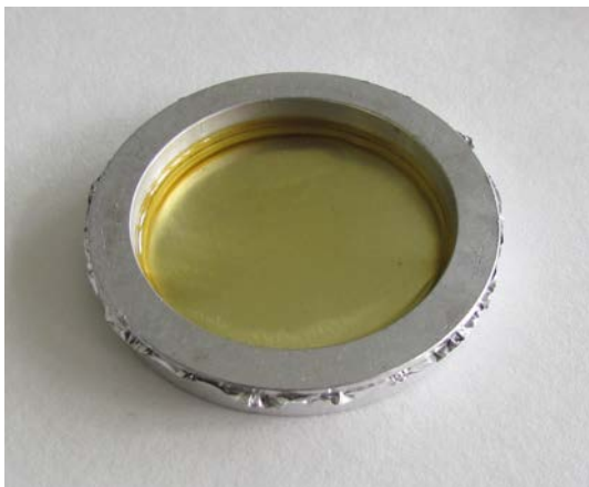
Abbildung D.1: Aus der Schmelze in eine Probenform gegossene Kolophonium-Schicht.
