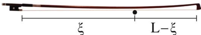
Abbildung 14.1: Saitenposition \xi : Position der Saite ( \bullet ) am Bezug, dessen Gesamtlänge L ist. Über die periodische Saitenschwingung wird dabei gemittelt.
