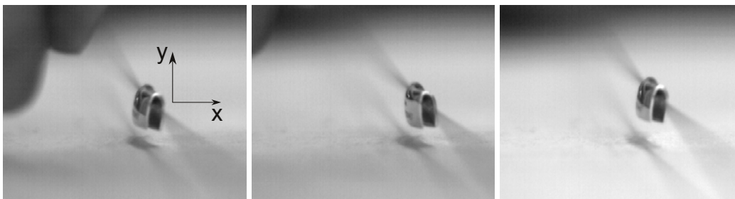
Abbildung 4.11: Wolfstimmer auf Monochord, aufgenommen mit Hochgeschwindigkeitskamera: Drei Frames (bei t = 83 ms, t = 108 ms und t = 440 ms) aus der in Abbildung 4.12 analysierten Aufnahme.
