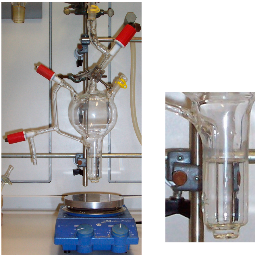
Abb.6.2: Entwickelter Reaktor für die NCA-Polymerisation. In der linken Abbildung ist der Probenauslass sowie der Anschluss zur Hochvakuumlinie erkennbar. Im rechten Teil der Abbildung ist der Reaktionsraum vergrößert dargestellt. Das Rohr für die Probenentnahme geht bis in den unteren Teil des Reaktors.
