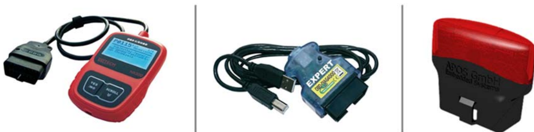
Abb.8: Zugriff mittels OBD: Diagnosegerät (XXLtech NX200, links), Datenkabel (Diamex AGV4000, Mitte), Bluetooth Adapter (APOS BT OBD 327, rechts)
