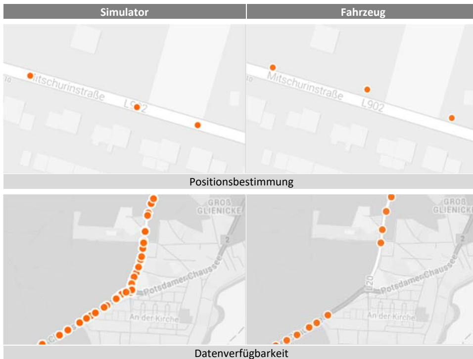
Abb. 25: Vergleich der durch Simulator und Fahrzeug erzeugten Daten: Genauigkeit der Positionsbestimmung (oben) und Verfügbarkeit der Daten (unten).
