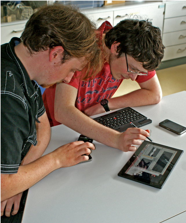
Abb. 3: Studenten untersuchen das Phänomen der Schwebung. Zwei Smartphones dienen als Schallquellen. Mit dem Tablet-PC werden diese akustischen Signale aufgenommen, dargestellt und verarbeitet.
