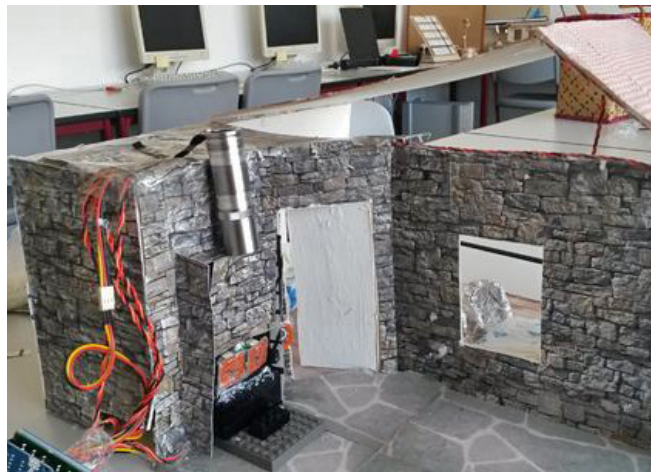
Im Arduino gesteuertes personenerkennendes Haus
