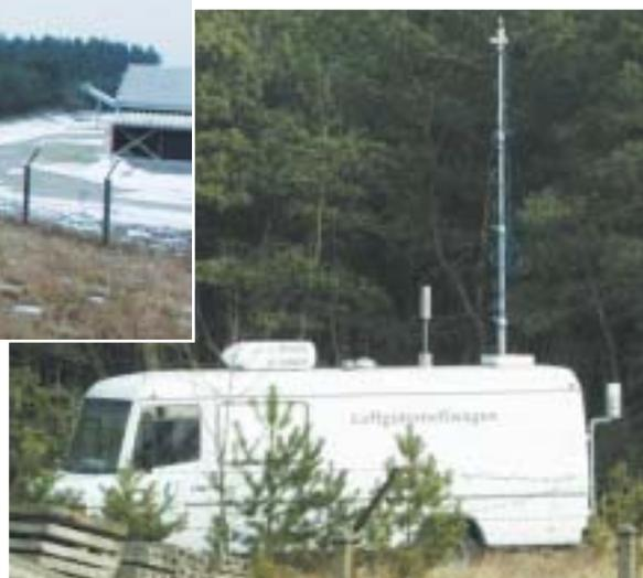
**Bild 2: Luftgütemesswagen am Messstandort** ▶
