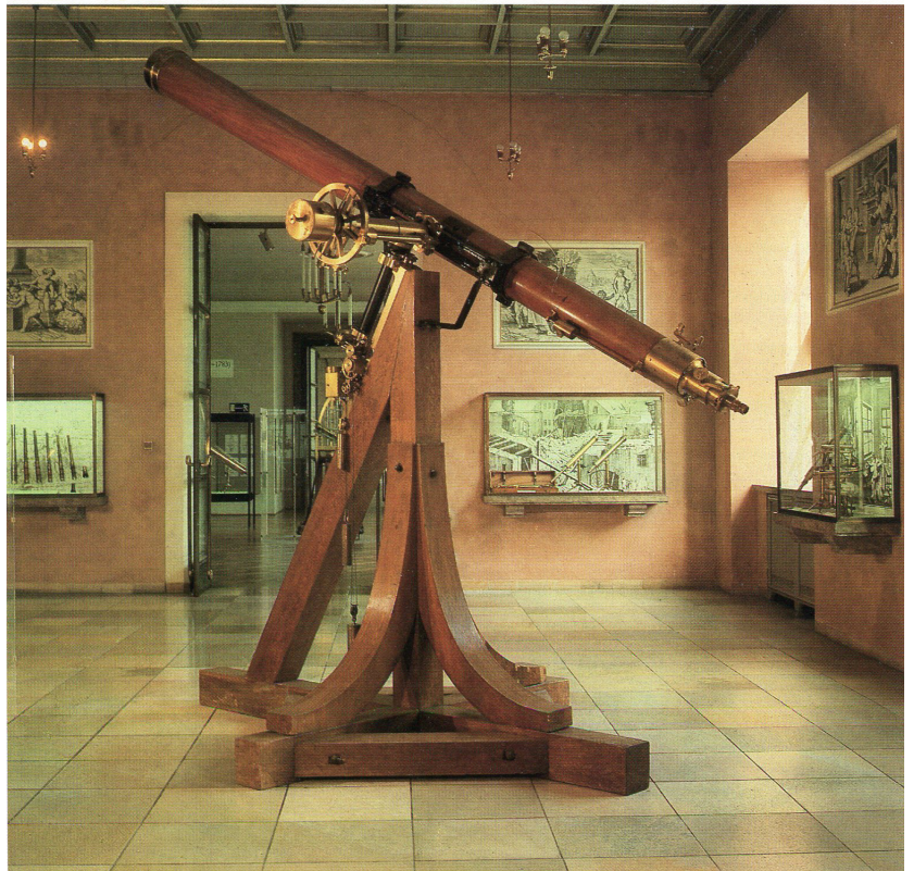
Abb. 1: Fraunhofers Refraktor der ehemaligen Königlich-Berliner Sternwarte in Berlin-Kreuzberg, jetzt im Deutschen Museum München (nach Riekhher 1990, Tafel VIII neben S. 193)
