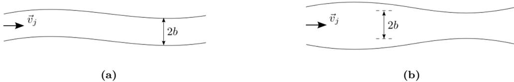
**Abbildung 5.3.:** (a) Sinusoidale Störung des Jets. (b) Variköse Störung des Jets.
