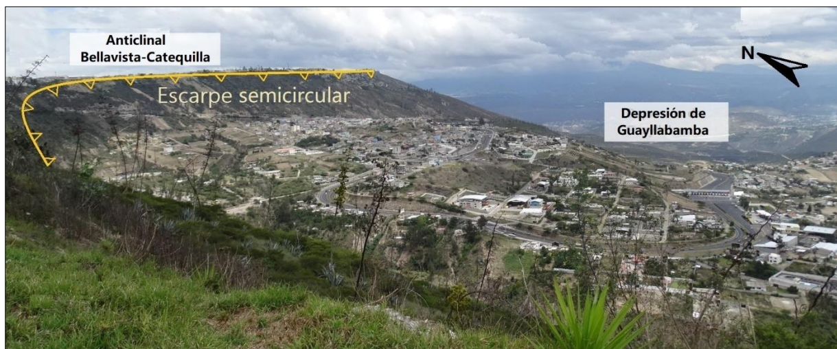
Fig. 1.1. Vista panorámica del gran movimiento en masa de Oyacoto ubicado en el flanco oriental del pliegue de Bellavista-Catequilla al norte de la cuenca intermontana Quito-Guayllabamba. El escarpe semicircular es el principal rasgo morfológico, bajo el cual se observan asentamientos urbanos.
