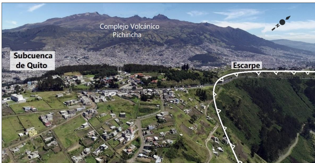
Fig. 4.4. Vista panorámica del escarpe circular del movimiento en masa MM-1 Conocoto. Fotografía tomada con dron proyecto Tomorrow's Cities 2020 .
