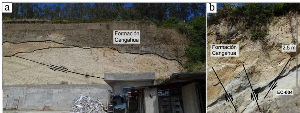
Fig. 4.20. a) Plano de ruptura gravitacional medido en depósito coluvial de remoción del MM-1 Conocoto ( N143^{\circ} \mid 15^{\circ}NE ) se pueden observar además distintas superficies de erosión y zonas de relleno. b) Deformación extensional con fallas directas asociadas al momento de flexión del pliegue en la zona de extensión cerca de la charnela en el flanco oriental del anticlinal de Puengasí.
