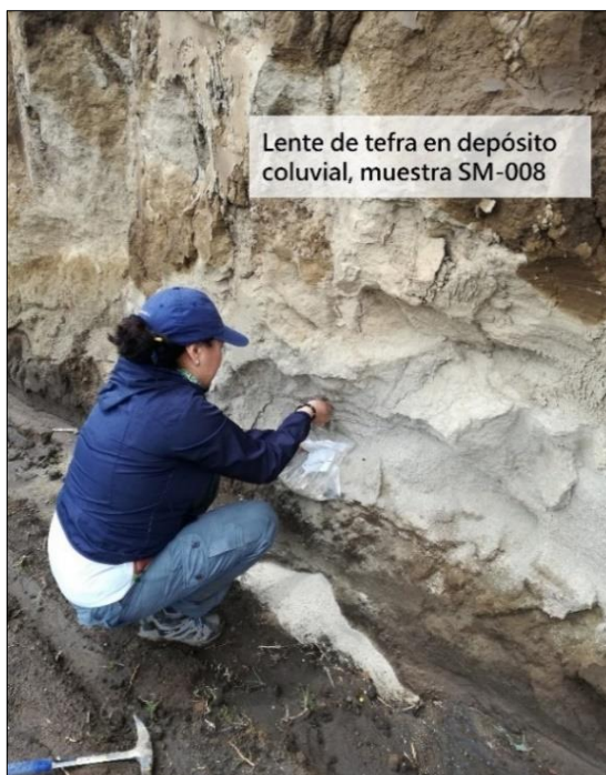
Fig. 4.36. Afloramiento de depósito coluvial de remoción en el movimiento en masa MM-1 Conocoto, se observa el lente de tefra volcánica de la muestra SM-008.
