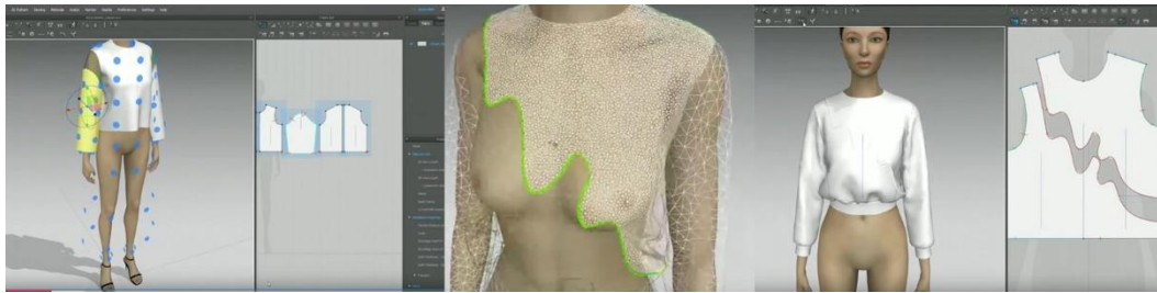
Abbildung 51) links: virtueller Entwurf am Avatar mit Messpunkten; Mitte: in der Visualisierung vorgenommene Modelländerung; rechts: Übertragung in die Schnittschablone 360
