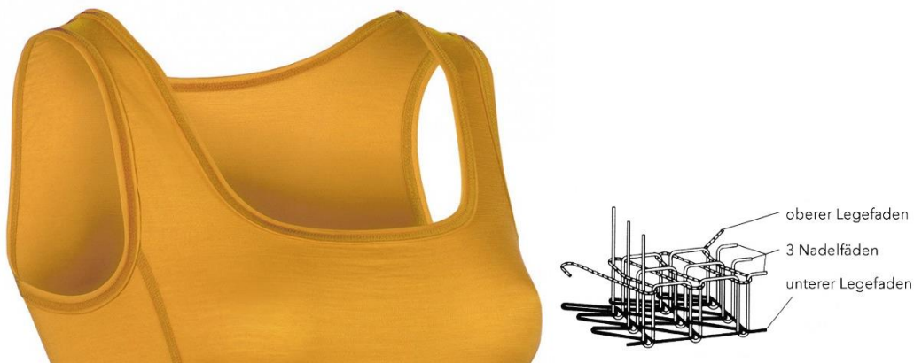
Abbildung 10) links: „Women’s Tank Top II Slim Fit“ – Merinounterwäsche, Flach- bzw. Covernähte an den Säumen der Ausschnittkante; rechts: nähtechnische Bezeichnung Dreinadel-Überdeckkettstichnaht mit Schemazeichnung; Das Nahtbild zeigt eine unterschiedliche Ober- und Unterseite, deshalb werden die Säume nach außen gewendet. 96
