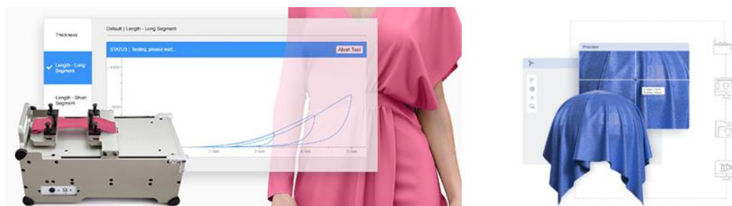
Abbildung 42) links: FAB Materialscanner, in den ein textiles Stoffstück eingespannt wird, um verschiedene Belastungstests durchzuführen, die Ergebnisse werden direkt in Zahlenreihen aufgezeichnet und so für jeden Stoff als Datensatz gebündelt; rechts: Beispiel der Bilddateien, die aus den Rohdaten des Materialscanners errechnet werden 317
