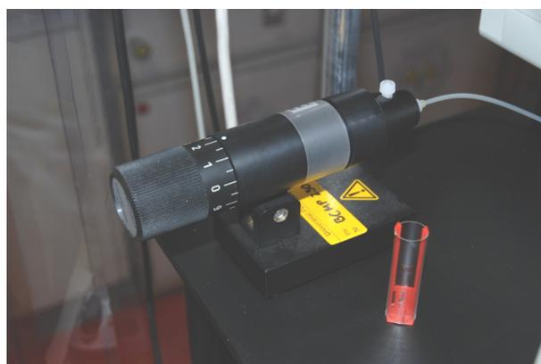
**Abb. 4: Druckmanipulator** zur Erzeugung eines dosierbaren Unterdrucks zum Ansaugen einer Zelle an die Mikropipette.
