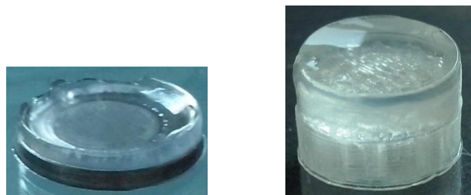
Abbildung 4.4. 14: Eigene Fotos vom 06.06.2016 und 29.09.2017 von betainbasierten Hydrogelen auf verschiedenen Oberflächen. Links – Titan mit dem Durchmesser von 1 cm; Rechts – 3D gedrucktes PLA mit dem Durchmesser von 1 cm.
