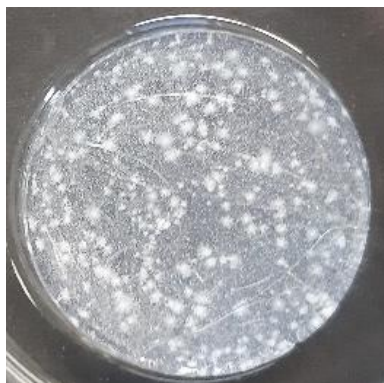
Abbildung 4.2. 24: Eigenes Foto vom 10.10.2019 des Hydrogels B10 mineralisiert mit \text{CaCl}_2 -Lsg. und \text{Na}_2\text{CO}_3 -Lsg. bei 37^\circ\text{C} .
