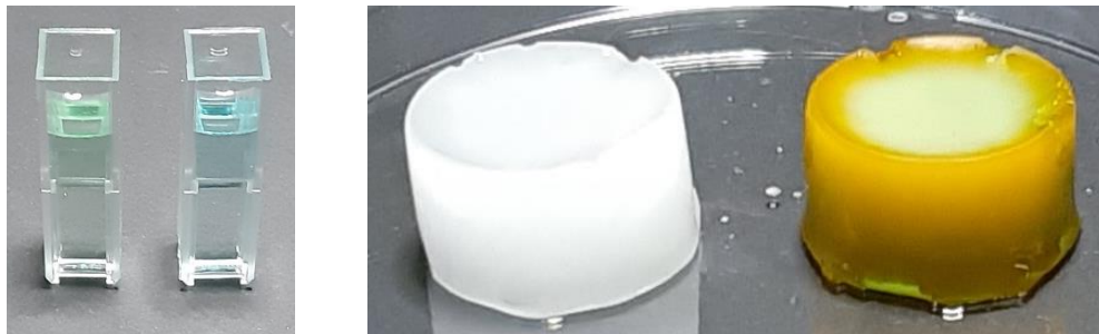
Abbildung 4.4. 5: Eigenen Fotos vom Mai 2020 zur Demonstration der selektiven Adsorption von MO gegenüber MB. Links – Küvetten mit den gemessenen Lösungen mit 200 \mu L Probenlösung und 1,8 mL Reinstwasser. Die linke Küvette enthält die Probenlösung zu Beginn der Experimente und die rechte Küvette die Lösung mit der Probenlösung nach 24 h. Rechts – Kryogel zu Beginn des Experimentes (links) und nach 24 h (rechts).
