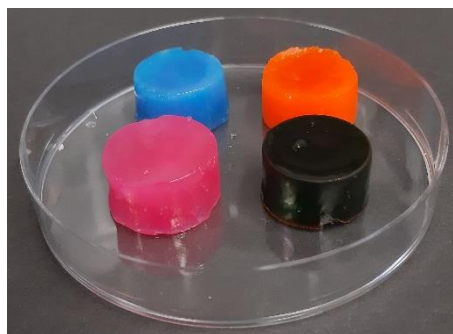
Abbildung 4.4. 2: Eigenes Foto vom 04.05.2021 vom Kryogel in diversen Medien für 1 d gequollen. Blau: Methylblau; Orange: Methylorange; Rosa: DMEM; Grün; Bromthymolblau. Bei Zugabe von \text{HCl} (aq) kann der Farbumschlag nach Orange beobachtet werden. Dies ist mit \text{NaOH} (aq) reversibel. Durchmesser der Kryogele ca. 2,3 cm.
