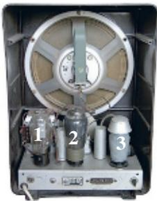
Abb. 2: „Volksempfänger VE 301 Wn von innen (Röhren mit Zahlen markiert)“<sup>17</sup>
