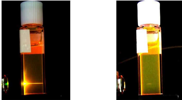
**Abb. 5.13:** Vergleich zwischen den Anregungsfoki einer OPEF bei  $\lambda_{exc} = 542$  nm und einer TPEF bei  $\lambda_{exc} = 810$  nm in einer Rhodamin6G / Ethanol-Lösung. Der langgestreckte Fokus der TPEF begründet sich in der geringen Numerischen Apertur ( $NA = 0,25$ ) des Mikroskopobjektivs sowie in höheren Brechzahl der Farbstofflösung gegenüber Luft.
