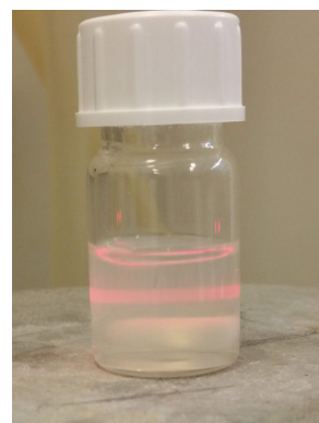
Abbildung 4.80: TYNDALL-Effekt bei einer Lösung von 123 in DCM.
