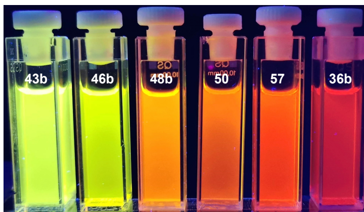
Abbildung 5.1: Vergleich der Fluoreszenz von verschiedenen S 4 -DBD-Fluorophoren in EtOH.
