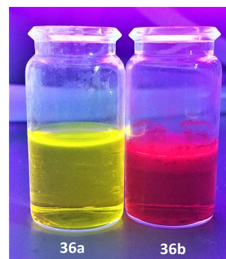
Abbildung 4.10: Die Fluoreszenz der S 4 -DBD-Aldehyde 36a und 36b in DCM.
