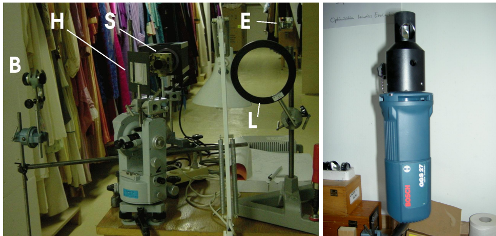
Abbildung 8.2.: Der in (Theilmann & Maier, 2004) beschriebene Aufbau zur Messung der Lichtgeschwindigkeit nach der Drehspiegelmethode: Im linken Bild sieht man in der Mitte einen Spalt S, der von der Metalldampfampe dahinter ausgeleuchtet wird; das Licht fällt von dort auf den Drehspiegel D (rechtes Bild), der etwa 4 Meter hinter dem Photographen des linken Bildes vorzustellen ist. Im linken Bild erkennt man ausserdem auf der rechten Seite die Linse L und, ca. 10 Meter weiter entfernt, den Endspiegel E. Im Vordergrund ist auf einem Theodoliten ein halbdurchlässiger Spiegel H montiert. Er ist so aufgestellt, dass ein Teil des durch E reflektierten, “zurücklaufenden” Lichtes auf ein Okular mit Längenskala zur Beobachtung des Spaltbildes (B) gespiegelt wird. Der Aufbau steht in einem Kostümfundus, einem ruhigen Ort mit genügend Platz für die erheblichen “Laufstrecken”...
