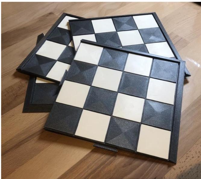
Abbildung 15: Das 3D-gedruckte Schachbrett mit simplem Steckmechanismus
