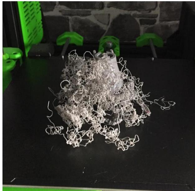
Abbildung 5: Ein gescheiterter Druck in Folge verloren gegangener Druckbetthaftung
