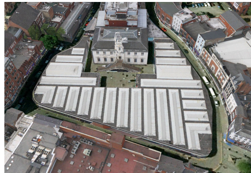
(b) Mit Vermeidung von Rohtexturwechseln: Es wird nur ein einziges Schrägluftbild zur Texturerzeugung verwendet. Texturfehler werden vermieden.
