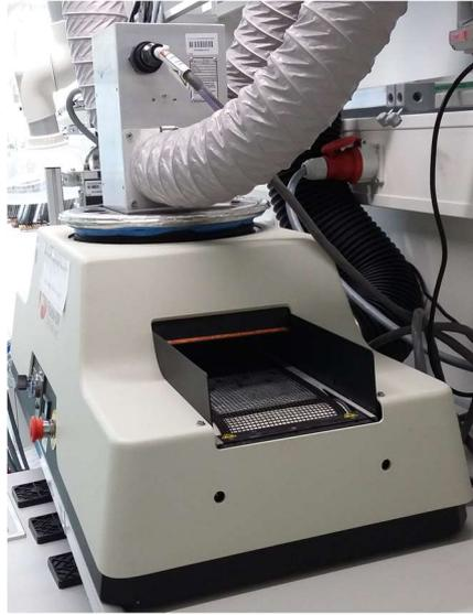
Abbildung 5-2: Seitliche Aufnahme der Bandanlage für die photochemische Polymerisation der Polymerfilme.
