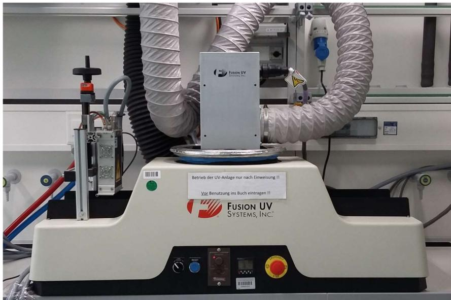
Abbildung 5-1: Fotografie der Bandanlage, welche mit einer UV Lampe und einer LED Quelle ausgestattet war.
