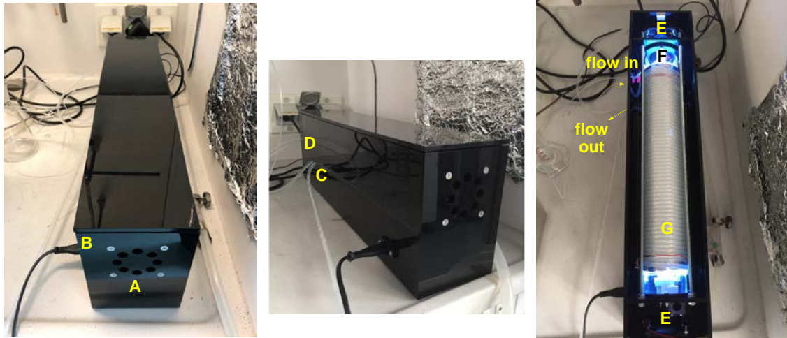
Abb. 4.25 Zweiter Prototyp eines zylindrischen Durchflussreaktors fotografiert aus unterschiedlichen Perspektiven; links (Vorderansicht in geschlossener Form): A) Lüftungslöcher, B) Netzanschluss; Mitte (seitliche Aufnahme): C) Ein- und Auslass für die interne Wasserkühlung bestehend aus Silikonschläuchen; D) FEP-Schläuche; Rechts (obere und geöffnete Ansicht): E) Lüfter; F) UV-Lampe (Modell: PL-L- Philips, Leistung: 36 W); G) Wasserkühlung
