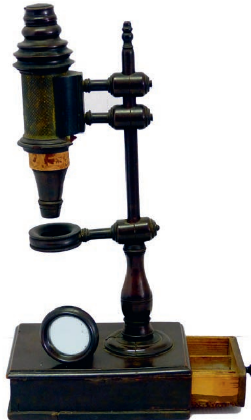
Abb. 6: Sogenanntes Nürnberger Mikroskop; hier das Modell mit dem Kastenstativ. Das Mikroskop stammt aus dem Besitz Ehrenbergs, Ehrenbergsammlung Museum Barockschloss Delitzsch, Foto: Jürgen Geisler, Museum Barockschloss Delitzsch.
