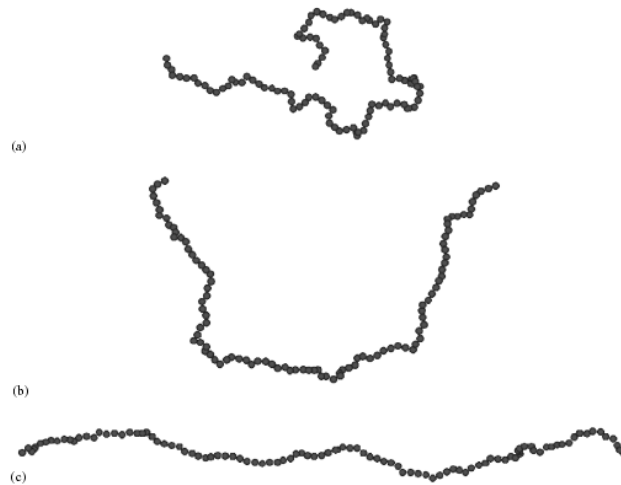
Abb. 2.2: Mont-Carlo-Simulation der Struktur eines PE mit 100 Monomeren. Die Elektrolytkonzentration nimmt von (a) nach (c) ab. Abbildung entnommen aus [27].
