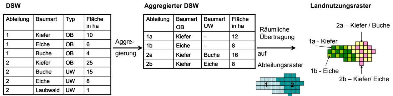
Abbildung 25 - Schematische Darstellung der Übertragung und Aggregation der Landnutzungsdaten vom Datenspeicher Wald auf ein Raster
