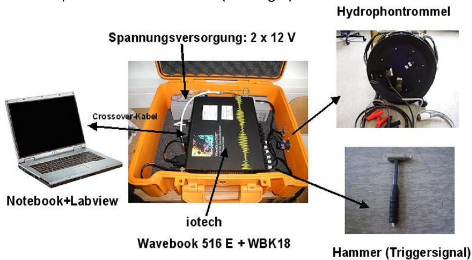
Abbildung 7.9: BAM-Messsystem Parallel-Seismik mit Anschlüssen.
