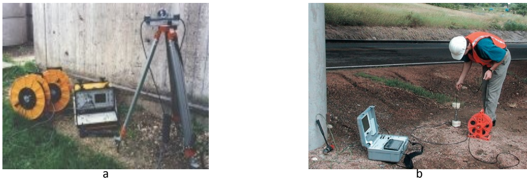
Abbildung 3.2: Kommerzielle Parallel-Seismik Ausrüstungen der Firmen CEBTP (a) und Olson Engineering (b).
