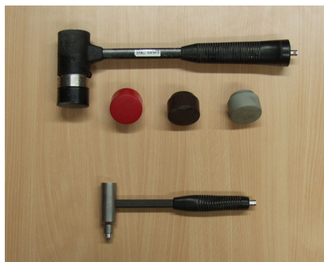
Abbildung 7.1: Impulshämmer PCB Piezotronics 086D20 (1,1 kg, oben, mit verschieden harten Schlagkappen) und 086C03 (0,16 kg, unten). Weitere Betrachtungen mit schwarzer (hart) und grauer Kappe (weich).
