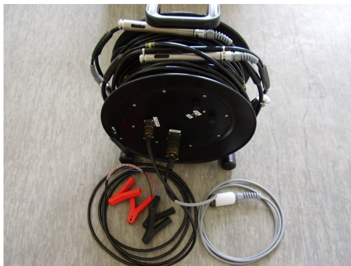
Abbildung 7.6: Hydrophontrommel mit 6 Sensoren (Abstand je 0,5 m) und integrierten Vorverstärkern. Geotomographie GmbH für BAM.
