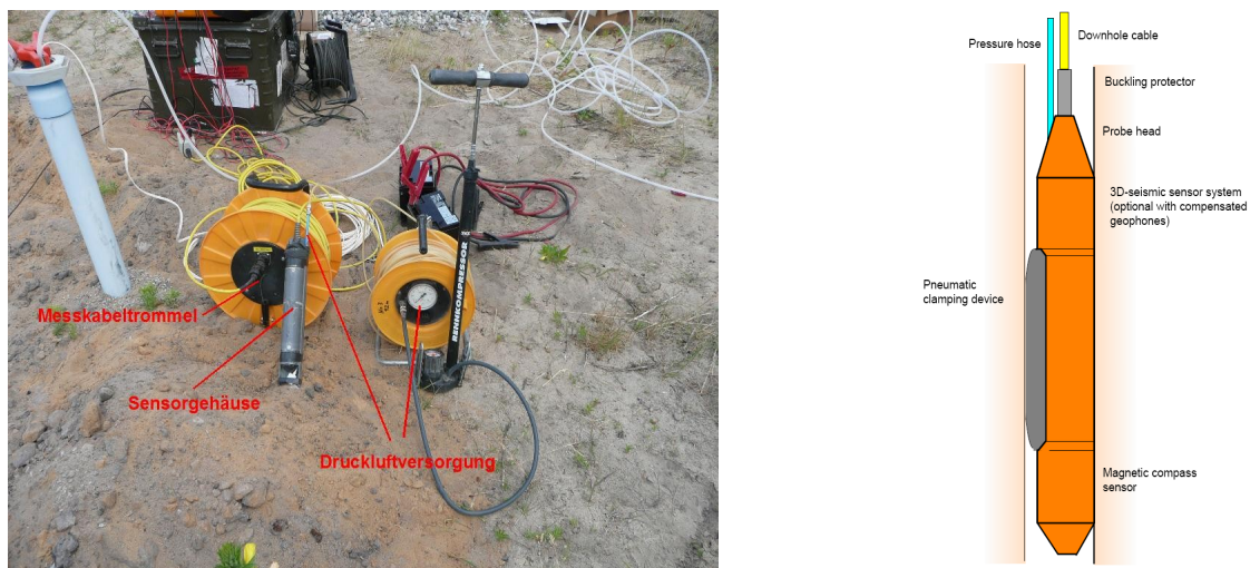
Abbildung 7.8: Bohrlochgeophon BGK5 (Geotomographie GmbH) im Feldeinsatz auf dem BAM-Testgelände Horstwalde (links), Prinzipskizze (rechts, Geotomographie GmbH).
