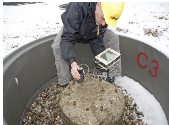
Abbildung 9.1: Links: Prinzip der Pfahlintegritätsprüfung nach der Hammerschlagmethode. Oben: Pfahlintegritätsprüfung auf dem BAM-TTS in Horstwalde.
