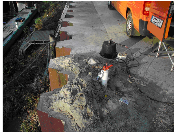
Abbildung E.1: Spundwand auf dem Gelände der Firma Hollandboot. Links: Übersicht. Rechts: Detail mit Bohrloch und Parallel-Seismik-Sensorkabel
