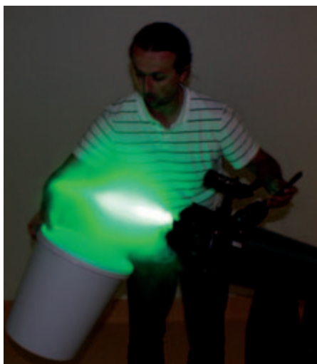
Trockenübung im Labor: Der Strahl eines Lasers durchläuft ein Teleskop und wird so aufgeweitet. Dieser Strahl würde Messungen über große Entfernungen erlauben.
