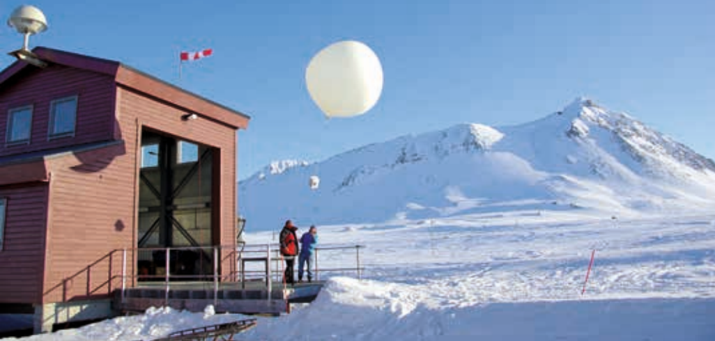
Ozonsondenstart an der Forschungsstation Ny-Ålesund auf Spitzbergen. Foto: J. Graeser
