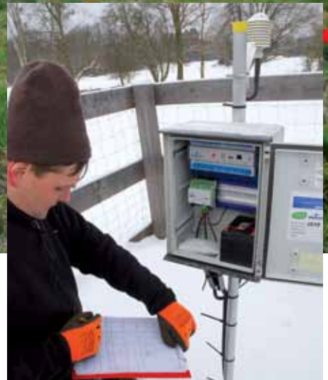
100 Klimastationen im Exploratorium Schorfheide zeichnen ganzjährig Temperatur und Feuchtigkeit im Boden und an der Luft auf. Foto: M. Gleisberg
