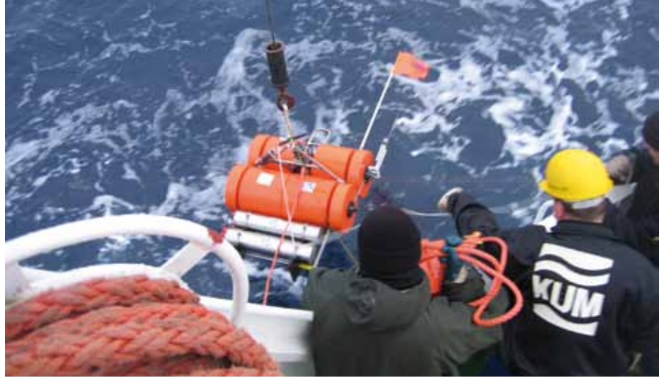
Maßarbeit: Das Ozeanbodenseismometer darf nicht an die Bordwand schlagen.
