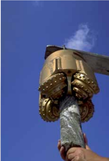
Wichtiges Utensil: Mit dem Rollenmeißel werden Kerne in kristallinen Gesteinen erbohrt. Foto: DOSECC
