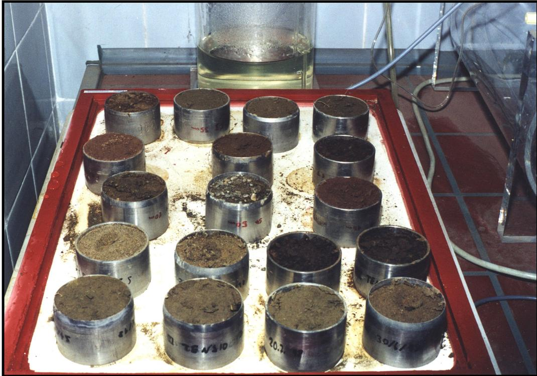
*Abb. 2 : Poröse Keramik-Platte zum Erstellen der Wasserspannungs-Kurve*
