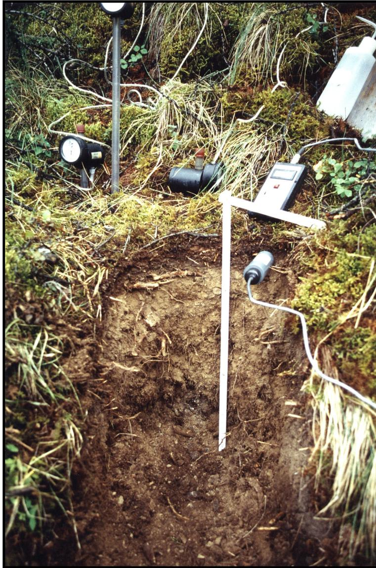
*Abb. 8 : Einsatz von Tensiometern und der Thetasonde an Station S 7*
