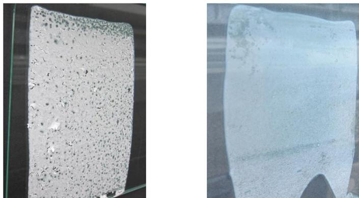
**Abb. 71:** Beschichtungen eines Hydroxybutylethers (MS: 0,79) aus Wasser (links) und Wasser-DEGBE (90:10) (rechts) mit einem Rakelspalt von 100  $\mu\text{m}$  auf Glasplatten.
