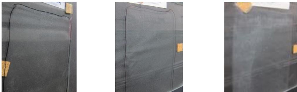
**Abb. 62:** Beschichtungen von Stärkepropionat (DS: 0,67; links), -butyrat (DS: 0,64; mitte) (zur besseren Sichtbarkeit schwarz umrandet), und Stärkehexanoat (DS: 0,36, vor 70 °C; rechts) (alle mit DEGBE) auf Glasplatten mit einem Rakelspalt von  $100\ \mu\text{m}$ .
