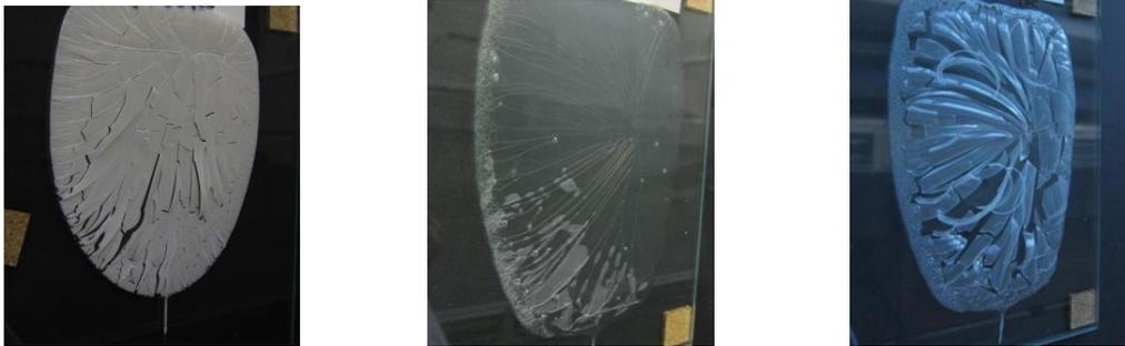
**Abb. 61:** Beschichtungen von Stärkehexanoaten bei 23 °C und 50 % LF (Klimaraum) (DS: 0,14 (links) und 0,36 (mitte)) und 21 °C und 35 % LF („normales“ Labor) (DS: 0,36 (rechts)) mit 20 % DEGBE auf Glasplatten mit einem Rakelspalt von  $1000\ \mu\text{m}$ .
