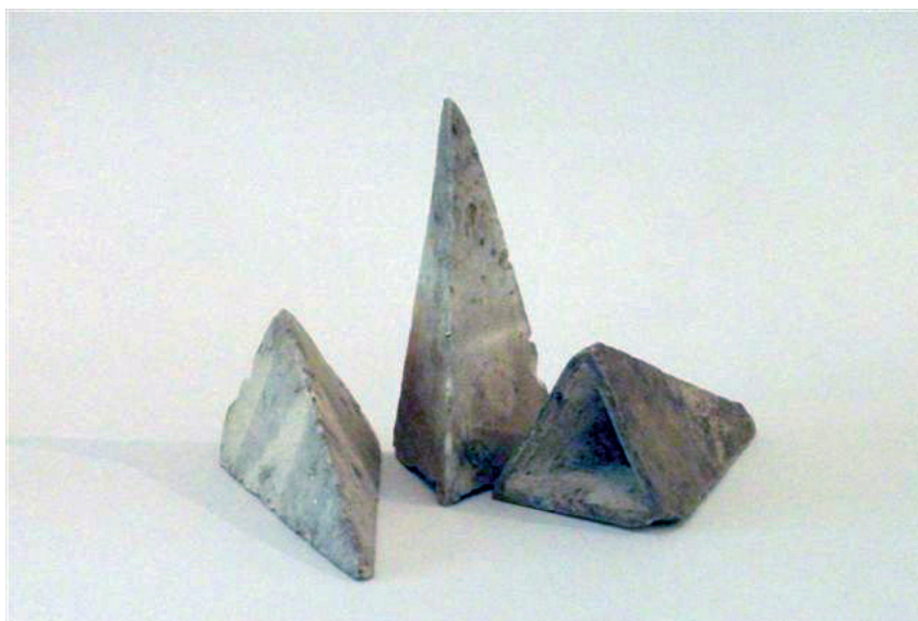
Abb. 7: Hohle Auflagepyramiden für das Brennen von Steingut, gefunden im Innenhof des ehemaligen Fabrikgebäudes der Fayence- und Steingutmanufaktur Rheinsberg. Foto: Schink
