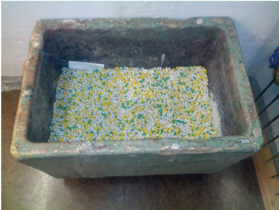
Abb. 9: Hafen für die Schmelze von Glasknöpfen oder Glasperlen, ausgestellt im Fichtelgebirgsmuseum Warmensteinach. Quelle: eig. Aufnahme
