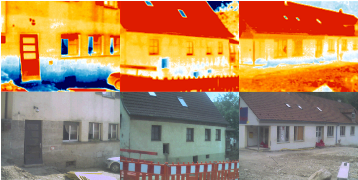
Abbildung 14: Wärmebilder (jeweils oben) und RGB-Normalaufnahmen (unten) von drei betroffenen Gebäuden.
