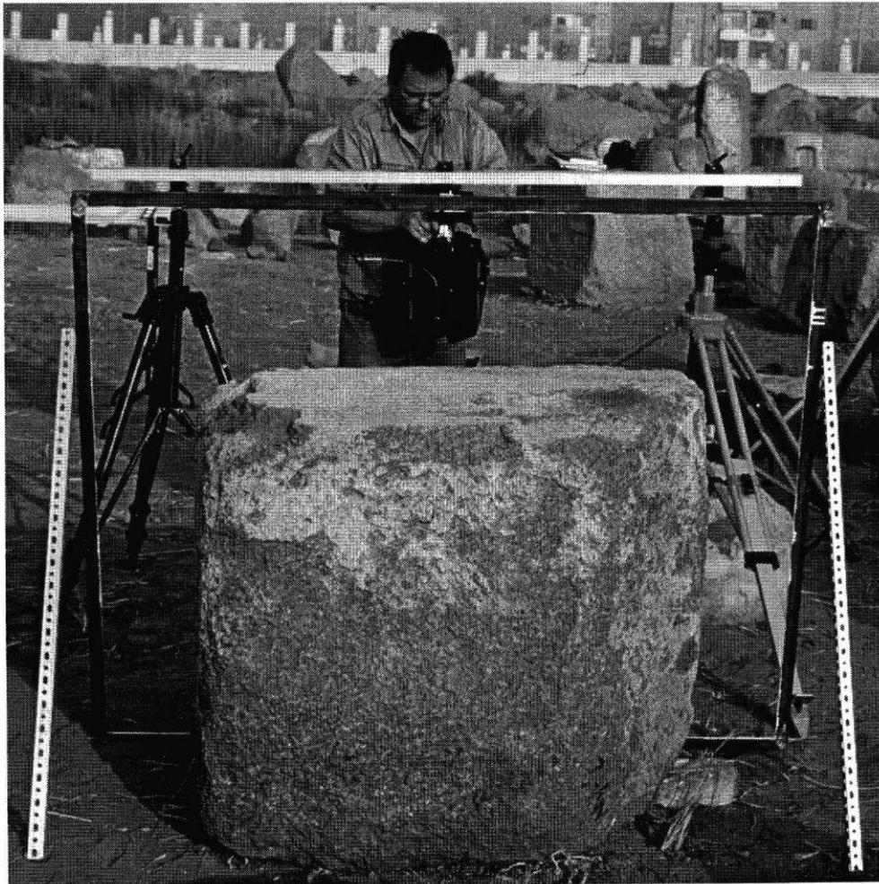
Abb. 1: Positionierung der Kamera auf dem Metallrahmen vor dem Relief
