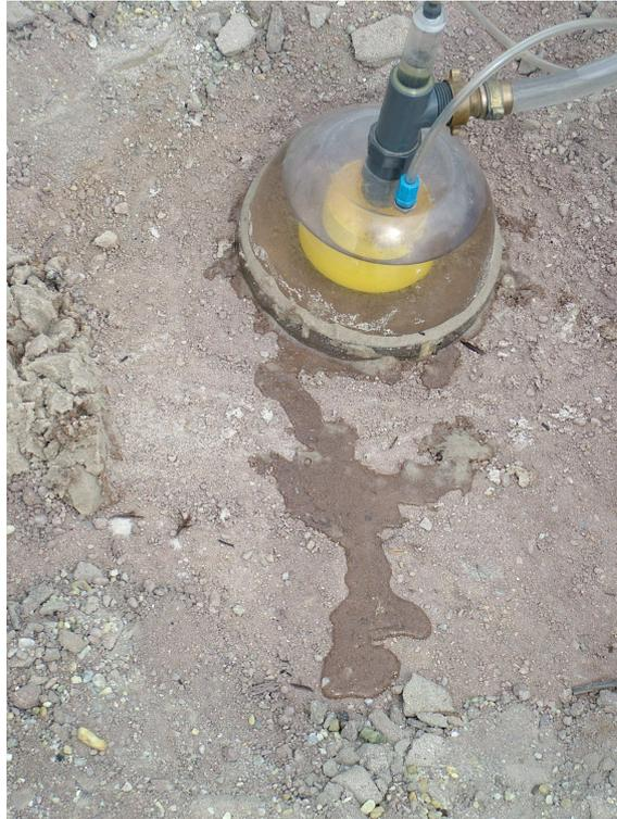
Abb. 2.8: Messung der Infiltration mit einem Haubeninfiltrimeter auf einem hydrophoben Boden am 14. August 2006. Das Wasser unter der Haube infiltriert, während es neben der Haube nicht versickert.
