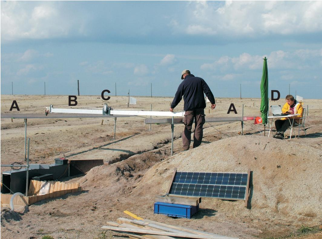
Abb. 4.6: Punktuelle Lasermessung: Die dargestellte Messapparatur ermöglicht eine punktuelle Differenzmessung an der Bodenoderfläche. Auf zwei Schienen (A) ist eine bewegliche Schiene positioniert (B), an der ein Schlitten befestigt ist (C). An diesem Schlitten, der sich senkrecht zu der Bewegungsrichtung der Schiene bewegen lässt, ist ein Distometer befestigt, das punktuelle Abstandsmessungen ermöglicht. Die Messung ist computergesteuert (D).
