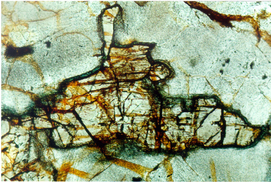
Abb. 1: Dünnschliff eines Corona-Metagabbros, Birgi. Zu sehen sind die Amphibol-Koronen um Orthopyroxen und die geringe Umwandlung der Plagioklase. Die Länge der unteren Bildkante entspricht 2,7 mm.
