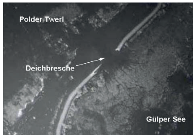
Abb. 2-7: Deichbresche am südlichen Teil des Polders Twerl, Aufnahmeterrmin des Luftbildes: 22.08.02, Breite der Bresche: ca. 70 m (herausgegeben durch das LUA Brandenburg)
