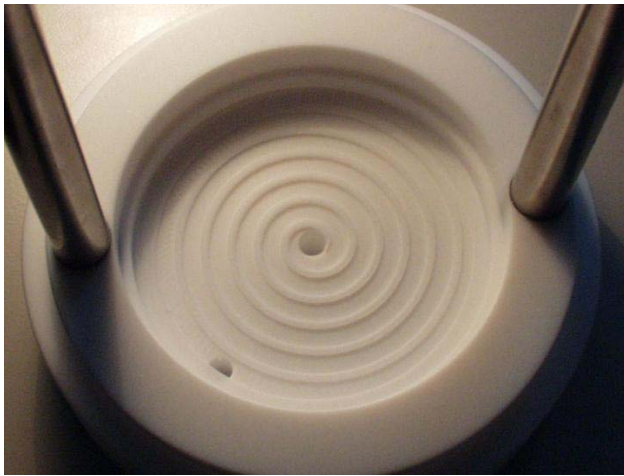
Abbildung 30: Photographie des wendelförmigen Kanals der in diesem Vorhaben entwickelten Membranemulgierungszelle. Die Kanalwandungen wirken als Stützstreben, auf denen die Membran aufliegt. Die kontinuierliche Phase wird durch die zentrale Bohrung zugeführt. Die schematische Darstellung (rechts) zeigt, wie die einzelnen Teile der Zelle zusammengesetzt werden. Der links dargestellte Kanal ist bereits mit der Membran bedeckt. Der Deckel liegt mit einem Viton-Dichtring auf dem Glaszylinder auf. Die Zu- und Abführstutzen im Unterteil und im Deckel sind nicht dargestellt.
