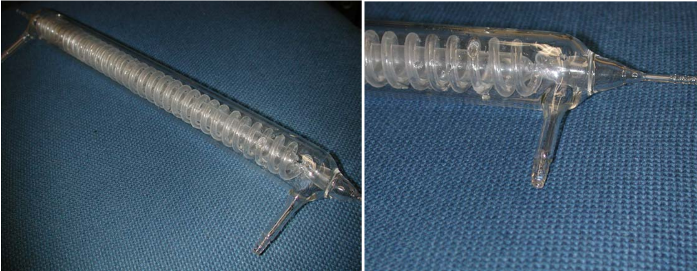
Abbildung 19: Photographien des Kühlers für die kontinuierliche Surviving Radical Polymerization. Der Ein- und Auslaß der Kühlspirale befinden sich am unteren bzw. oberen Ende des Kühlers, Das Kühlwasser vom Kryostat wird von den Seiten zugeführt und umströmt die Spirale in einer Gleichstromführung. In der Mitte der Glasspirale ist ein Verdrängerkörper (geschlossener Glaszylinder) zu erkennen, der eine größere Kühlleistung durch eine vergrößerte Strömungsgeschwindigkeit des Kühlmittels erlaubt.
