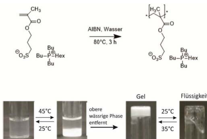
Abbildung 2.13: Oben: freie radikalische Polymerisation von Trisbutylhexylphosphonium-3-sulfopropylmethacrylat. Unten: reversibler Flüssigkeit-Gel-Übergang beim Erhitzen einer wässrigen 20 wt% Polymerlösung. [199]
