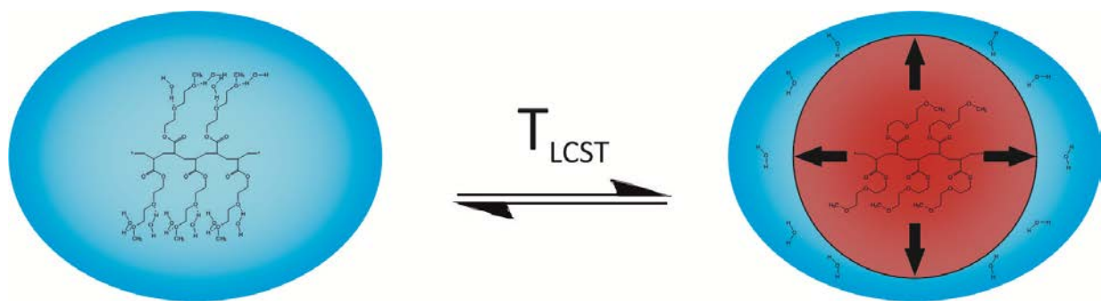
Abbildung 2.8: Schema für einen Phasenübergang am Beispiel des thermoresponsiven Homopolymers PMDEGA Poly(Methyl-di(ethylenglykol)acrylat).
