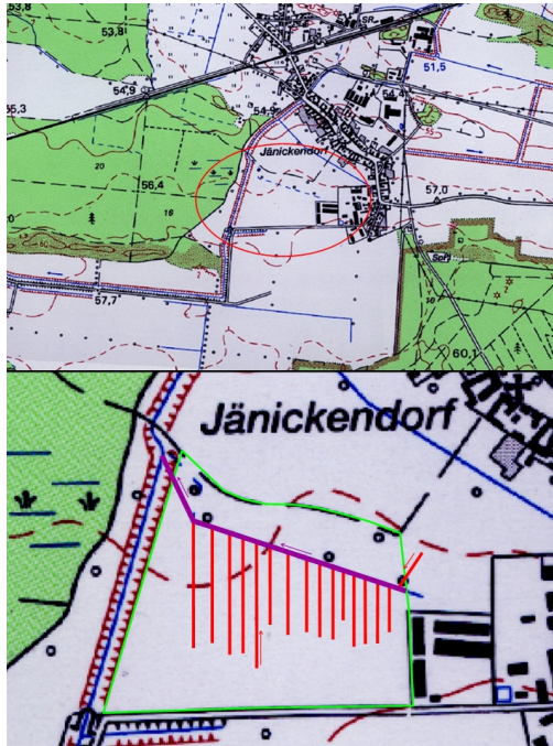
Abb. 13.2: Lage des Dränagenetzes auf dem Schlag „Nachtbucht“ der AG „Der Märker“
