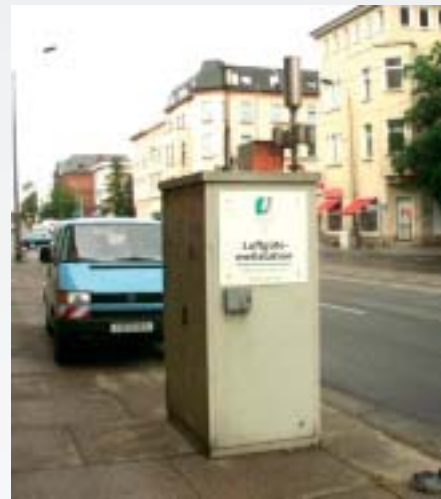
Beispiel einer Verkehrsmessstelle mit KleinfILTERgerät
