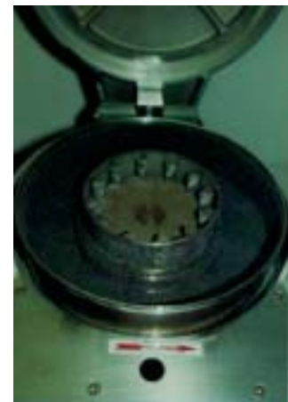
Zerkleinerungsprozess der Kabelummantelungen
