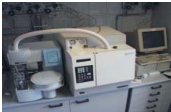
Messplatz zur Bestimmung der Ozonvorläufer mittels Thermodesorption und Kapillar-Gaschromatographie
