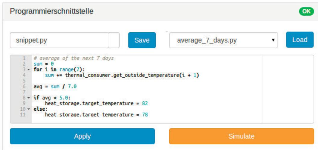
Abbildung 2.19: Programmierschnittstelle für Optimierungsalgorithmen
