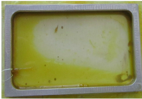
Abbildung A.2.: Foto eines Sylgard ® 184-Films ( \nu = 2,3 Gew%), der aus Lösungen mit einer Konzentration der Silikon-Komponenten von 20 Gew% im Gieß-Verfahren erstellt wurde. Nach dem Abdampfen des Lösungsmittels über Nacht erhält man einen mangelhaften Film.
