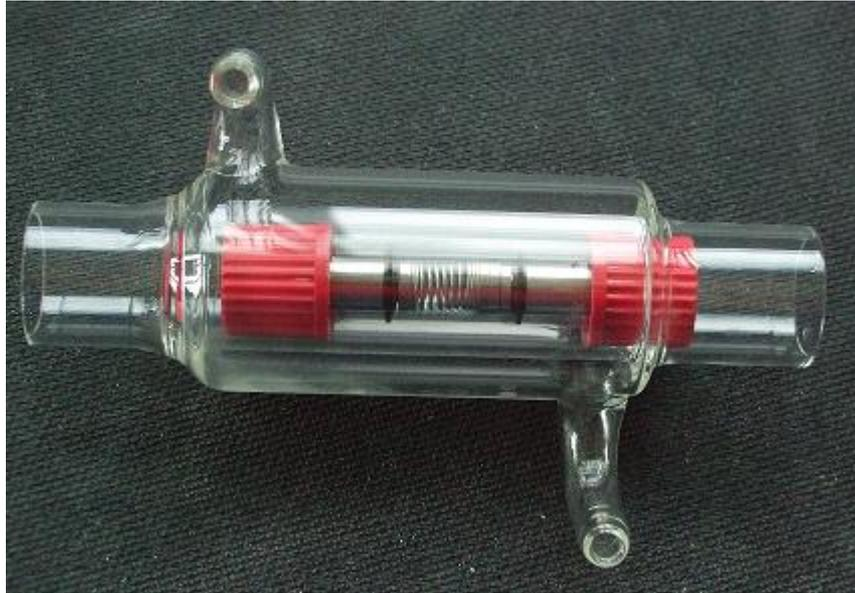
Abbildung 46: Testzelle in der verwendeten Glas-Wärmekammer (Foto: Dorian Grothe)
