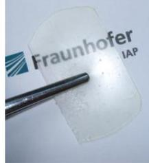
*Abbildung 44: Polymerfilm bestehend aus einer PEO-Matrix und einer IL-Komponente, hergestellt mittels Rakelverfahren (Foto: Dorian Grothe)*
