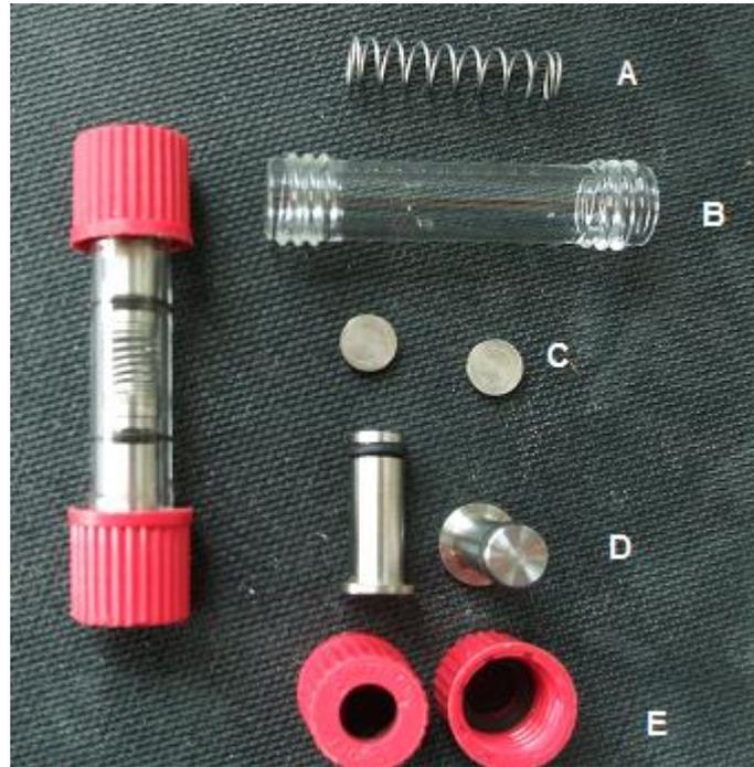
Abbildung 45: Die einzelnen Bauteile der verwendeten Testzelle: A: Spiraldruckfeder, B Glasdoppelgewinderohr, C: Edelstahlplättchen (Elektrodenträger), D Edelstahlstempel als Verschluss, E: Kunststoffgewindekappen mit Kunststoffdichtung (Foto: Dorian Grothe)
