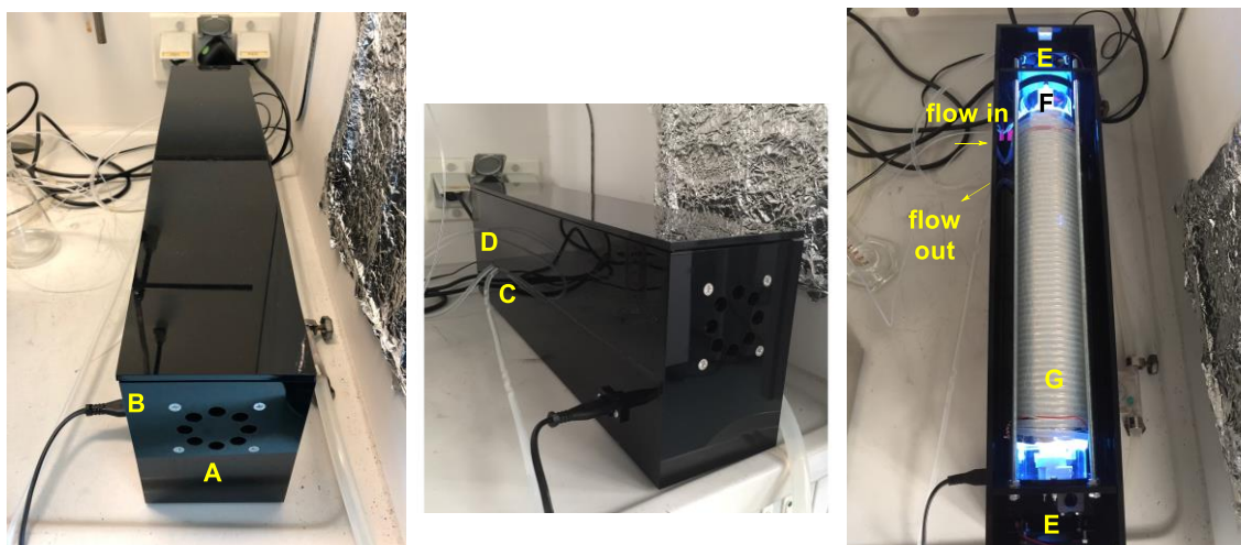
Abbildung 107: Aufbau des Durchflussreaktors links (Vorderansicht und geschlossene Ansicht): A) Lüftungsöffnungen, B) Stromversorgung; Mitte (Seitenansicht): C) Silikonschläuche als Wasser-Kühlungsein- und -auslässe. D) FEP-Schlauch. rechts (geöffnete Form): E) Ventilatoren, F) PL-L 36 W UV-Lampe (41.7 cm × 3.9 cm × 1.8 cm, 2G11 Sockel; Philips, Polen). G) Wasserkühlung. Abbildung wurde bereits veröffentlicht. [28]
