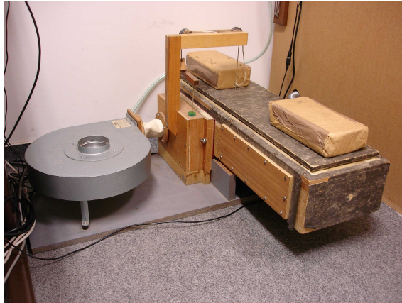
Abbildung 5.4: Winderzeuger, Druckregulierungsmechanismus und Balg (Windreservoir) der Messorgel.
