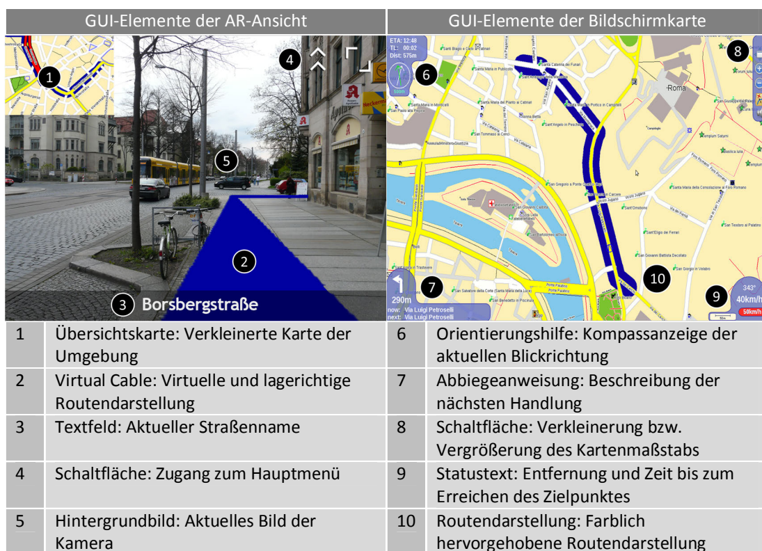
Abb. 4-26: Aufbau der graphischen Benutzeroberfläche, Quelle: (NAVIT-PROJECT, 2012)
