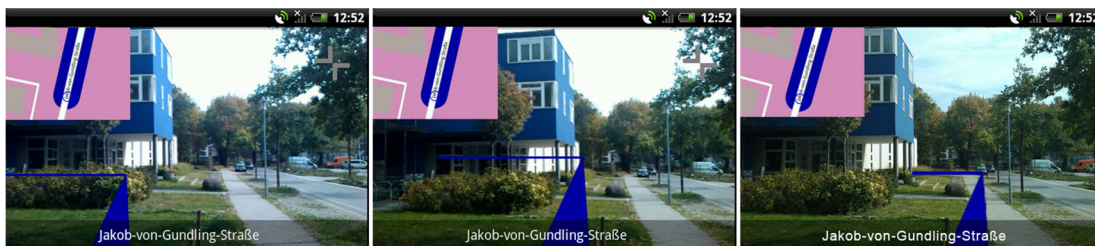
Abb. 4-20: Dynamischer Fehler des RealityView in einer Bewegungsphase
