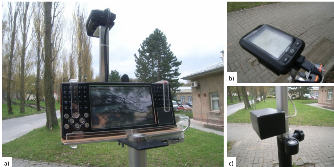
Abb. 4-17: Erste Prototypengeneration, UMPC (a), Kompass & GPS (b), Neigungssensor (c)
