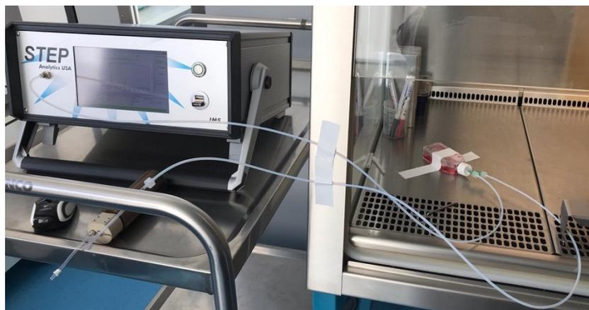
Abbildung 6 Direkte Probennahme in einer Zellkulturflasche mit der MCC-IMS
