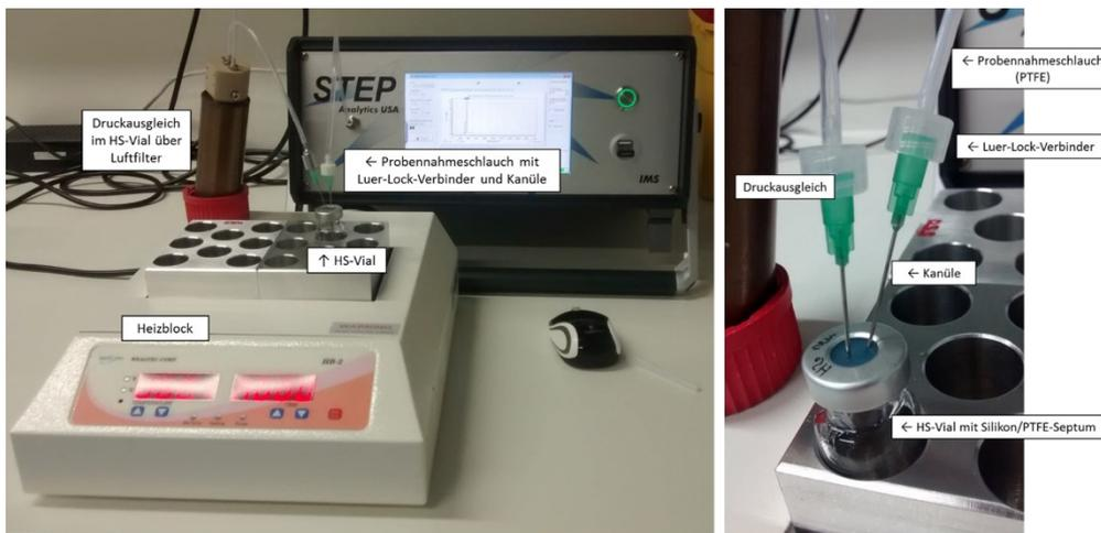
Abbildung 5 Probennahme einer Headspace-Probe mit der MCC-IMS
