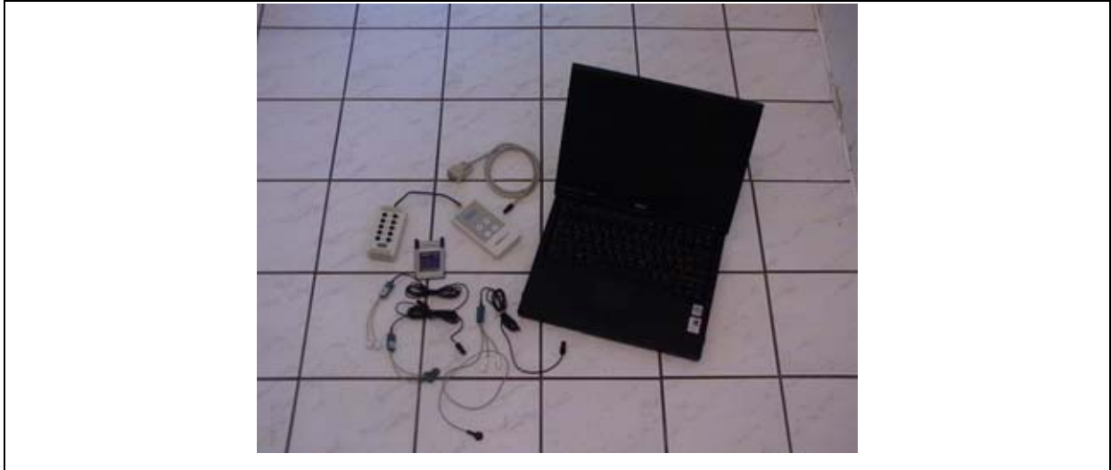
Abb. 40: Datenlogger, EMG–Elektrodenkabel, Flash–Karte und Notebook für mobile Messung im Freiwasser
