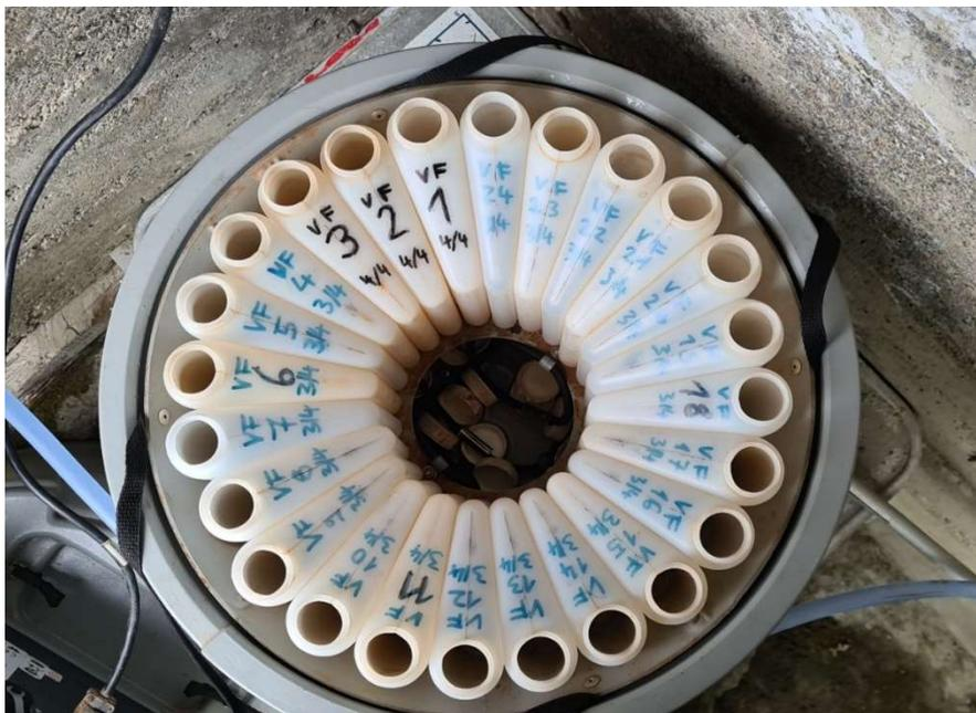
Abbildung 10: Ring des ISCO 6712 mit den dazugehörigen beschrifteten Flaschen.
